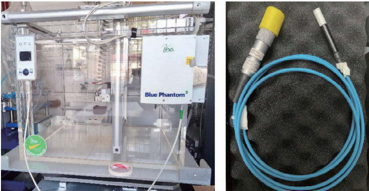
图 4 IBA 水箱和金刚石探测器实物图 Fig. 4 IBA phantom and diamond detector
