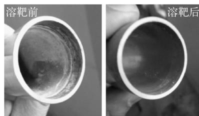
图 5  $\text{UO}_2$  镀层溶解前后的对比照片
